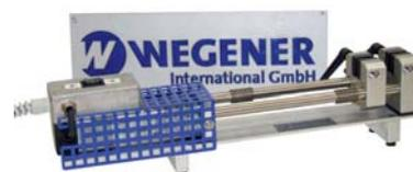
Es können Schälversuche nach DVS 2225-4/2226-3 und Zugversuche nach DVS 2203-2 durchgeführt werden.
